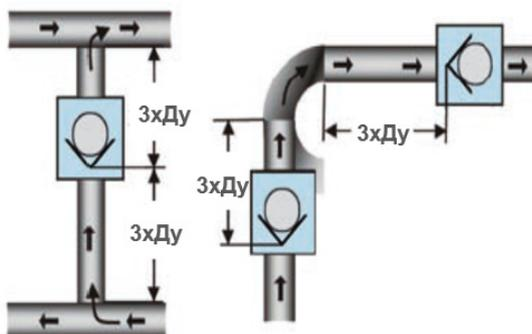
После запуска системы убедитесь в отсутствии протечек в местах фланцевого присоединения. Обеспечьте достаточное пространство вокруг клапана для будущих работ по техническому обслуживанию.
