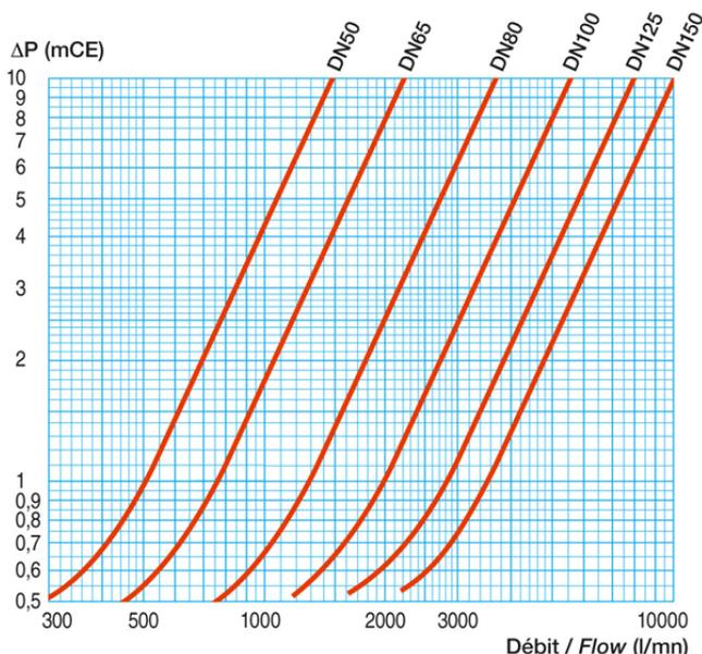
mCE : mètre colonne d'eau / meter water column
