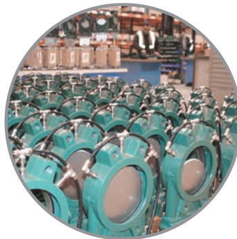
Válvulas guillotina DN 150 con actuador neumático con agujeros para alimentación de aire.
