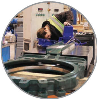
Ensamblaje y ajuste de motor eléctrico de válvula guillotina DN 500
