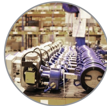
Válvulas mariposa equipadas de actuadores neumáticos doble efecto con accionamiento de emergencia.
