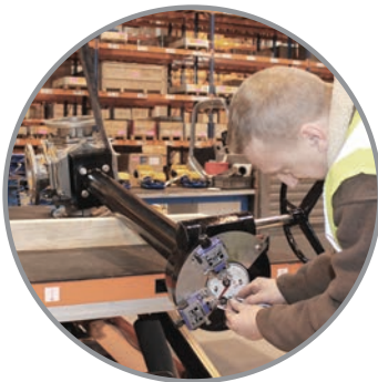
Ensamblaje y ajuste de contactos de posición final en reductor remoto para válvula de esfera en inox de 3 vías DN 80
