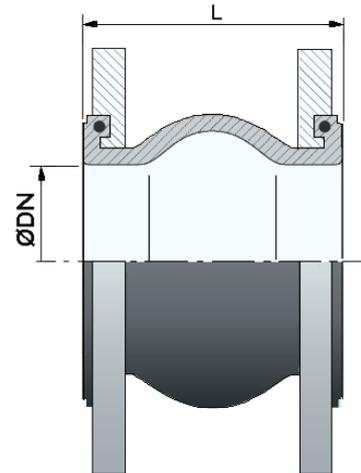
Raccordement PN10/16 jusqu'au DN150 et PN16 du DN200 au DN300 suivant les normes EN1092-1, DIN 3230, BS 6755 et ISO 5208.
