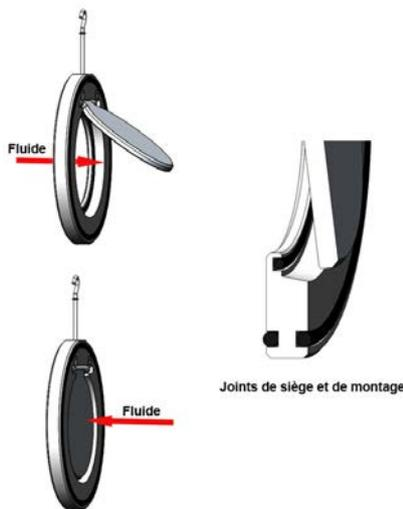
**!** Lors du montage il est recommandé de respecter une distance de 3 à 5 fois le diamètre nominal en amont et en aval d'un coude ou d'un appareil. Ceci permet de rester hors des zones de turbulence susceptibles d'augmenter le risque d'usure. Au refoulement d'une pompe il est conseillé de réaliser le montage conformément à la norme **FD CEN/TR 13932**
